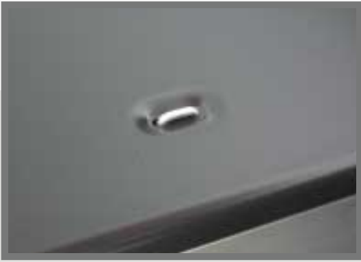
Zurröse, in Ladefläche versenkbar
