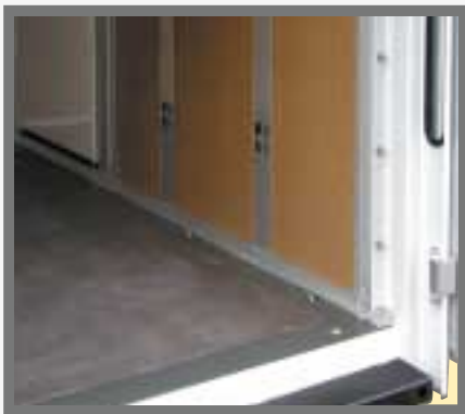
Ladefläche mit versenkbaren Zurrösen, Kangaroo.
