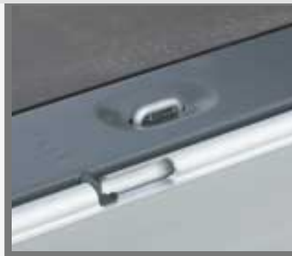
Verzurröse, kann in Ladefläche versenkt werden
